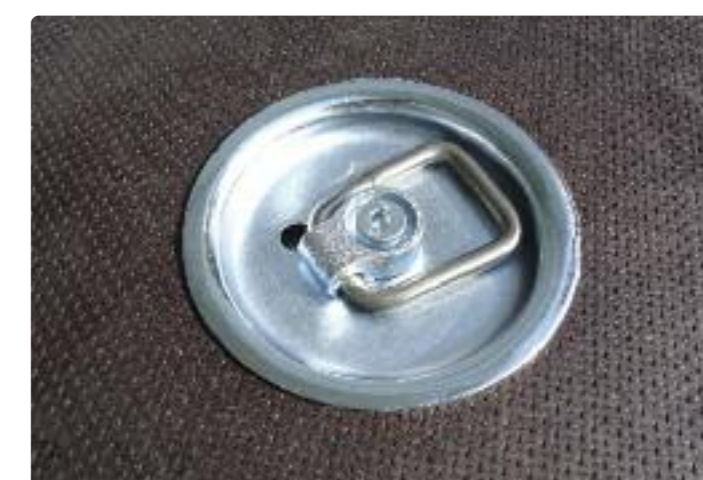
Zubehör: Zurring, im Boden versenkt Option : crochet d'arrimage en O intégré au plancher Optional extra: tie ring integrated into platform
