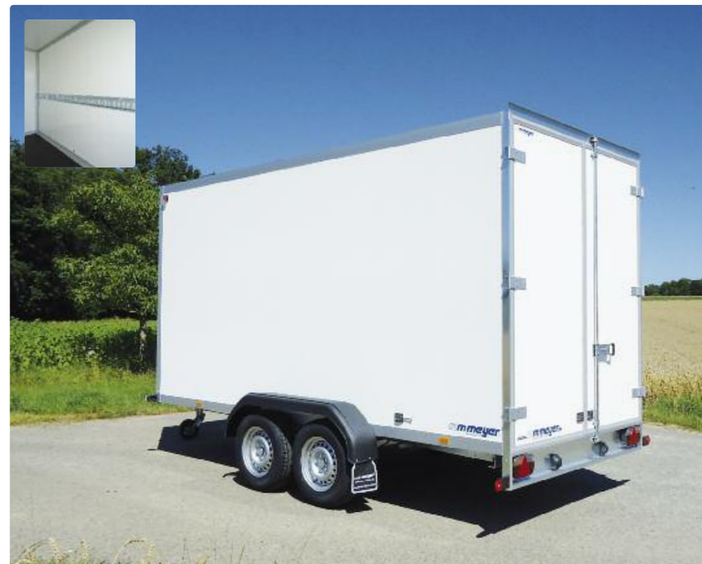
AZ 2740/185 Serie 35 Verstärkungen mit Filzstift angezeichnet; kleines Bild: Zurrleiste (Serie bei Innenlänge von 3.010 mm) AZ 2740/185 Série 35 Renforts indiqués avec stylo à feutre ; petite image : rail de fixation (en série : longueur intérieure de 3.010 mm) AZ 2740/185 Series 35 Reinforced sections indicated with felt pen; small picture: lashing rail (standard for interior length of 3,010 mm)
